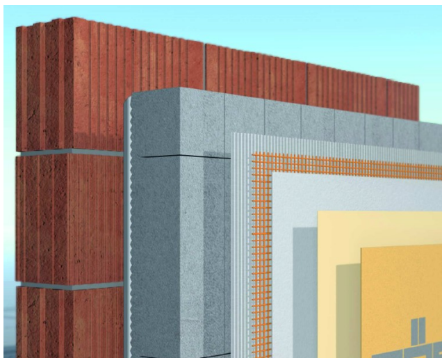
Tipico stratigrafia isolamento muri perimetrali
